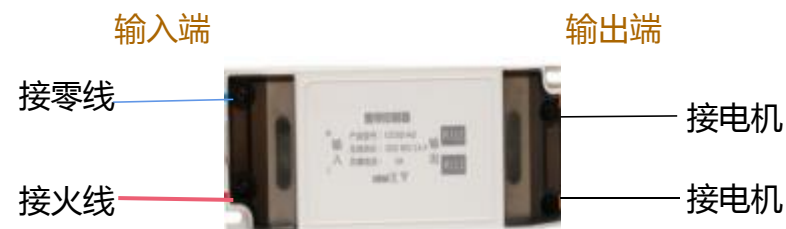
窗帘电机适配器接线图
