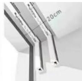
智能窗帘导轨安装示意图
